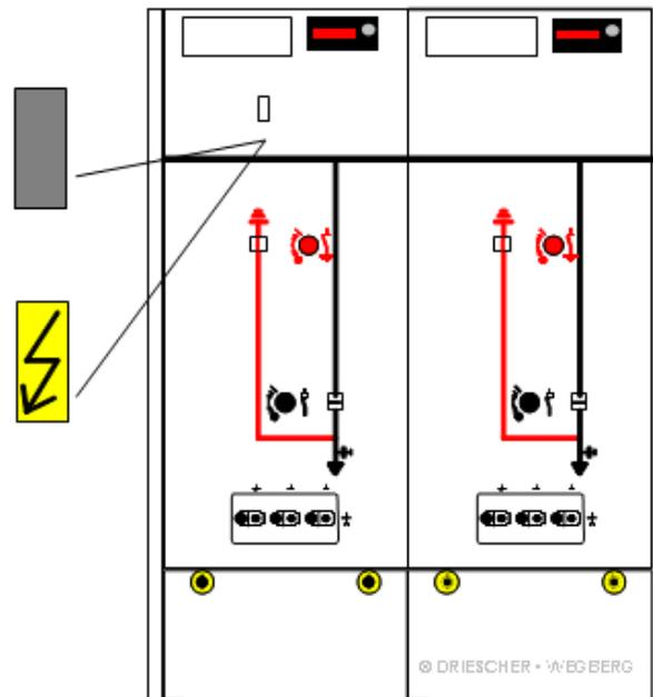
Die manuelle EIN- und AUS-Schaltung kann bei vorgespanntem Antrieb wie üblich vorgenommen werden. Lasttrennschalter und Erdungsschalter sind in der Standardausführung gegeneinander verriegelt. Die Verriegelung lässt allerdings die EIN-Schaltung des Erdungsschalters zur Störlichtbogenbegrenzung, über die **ABS**-Sensoren, unabhängig vom Schaltzustand der Gesamtanlage zu.
