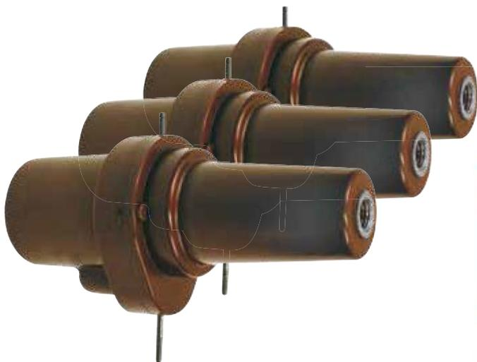
Die Konen für den Kabelanschluss oder die Anlagenerweiterung bestehen aus hochfestem, cycloaliphatischem Epoxidharz. Parallel zum hochspannungsführenden Teil der Durchführung ist im Epoxidharz eine Elektrode für die kapazitive Auskopplung eingebettet. Durch den Einsatz hochwertiger Epoxidharze und modernster Gusstechnik ist eine größtmögliche Sicherheit bezüglich der Isolationsfestigkeit des Dielektrikums und des Berührungsschutzes gegeben.
