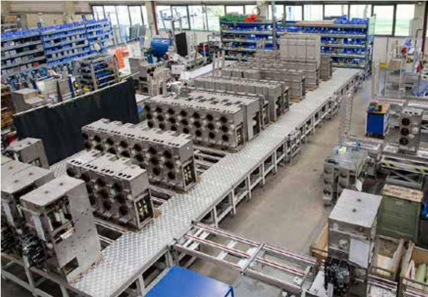
Die variablen Fertigungslinien für Kabel-, Transformator- und Leistungsschalterfelder sind der Garant für Qualität und Sicherheit. Hiermit können beliebige Anlagenkonfigurationen kurzfristig als Einzelfeld oder Anlage modular zusammengefügt werden.
