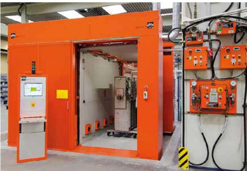
SF<sub>6</sub>-Dichtigkeitsprüfanlage für integrale Leckmessung
