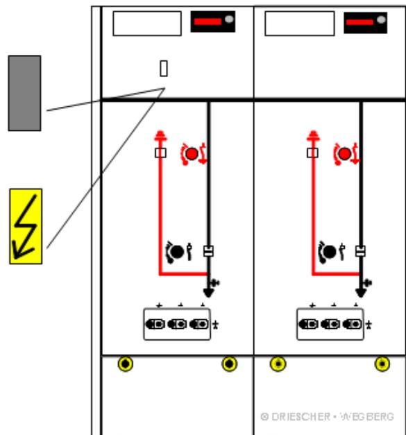
Die manuelle EIN- und AUS-Schaltung kann bei vorgespanttem Antrieb wie üblich vorgenommen werden. Lasttrennschalter und Erdungsschalter sind in der Standardausführung gegeneinander verriegelt. Die Verriegelung lässt allerdings die EIN-Schaltung des Erdungsschalters zur Störlichtbogenbegrenzung, über die **ABS**-Sensoren, unabhängig vom Schaltzustand der Gesamtanlage zu.
