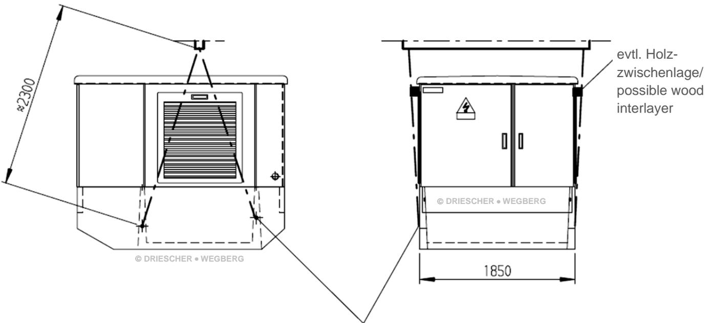
Trichterseilösen / funnel rope loops RD30x3,5
